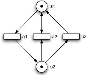
3. Considere a seguinte rede elementar livre de contactos que modela o comportamento de um elevador de um edificio de 2 pisos.
